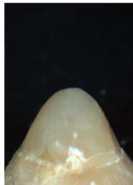
Abb. 15: Ein aus einem palatinalen Höcker eines OK-Molaren herausgeschliffener Schmelzantagonist
