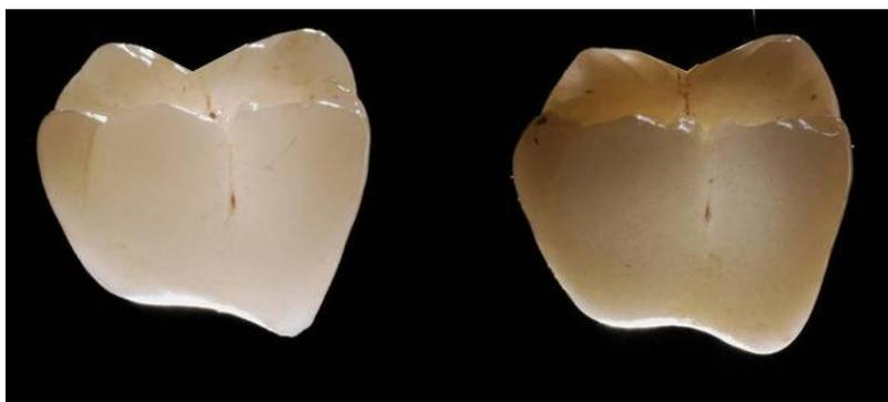
**Abbildung 2: Transluzenz von Lithiumdisilikat- (LS2) und Zirkoniumoxid- (ZrO2) Keramik im Durchlicht**
