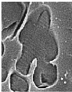
Abb. 6: Mittlerer Ausschnitt aus Abb.5 (vergrößert). Die Streifen auf den herausgelösten Flächen zeigen den lamellenartigen Aufbau der Leuzitkristalle, bedingt durch deren dendritisches Wachstum
