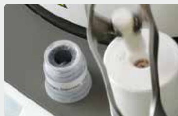
Anschliessend den mit Pulver benetzten IPS Alox-Kolben in die heisse Muffel geben.
