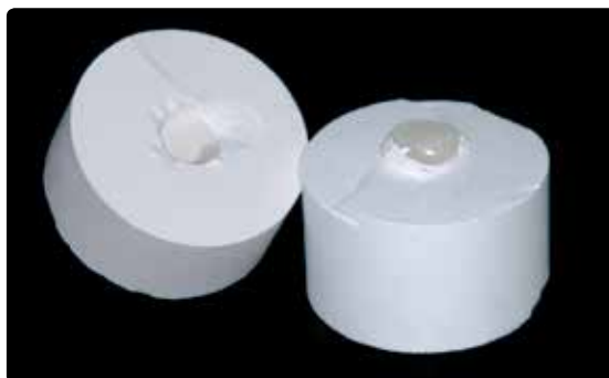
Muffel anschliessend an der markierten Stelle mit einer Trennscheibe trennen.
