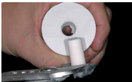
Dreht man den Alox-Kolben vorsichtig mit einer Zange aus der Einbettmasse so erhält man ihn bereits sehr sauber. Jedenfalls auf Sauberkeit überprüfen, ggfs. sandstrahlen mit \text{Al}_2\text{O}_3 .
