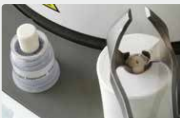
Kalten IPS InLine PoM Rohling mit dem Aufdruck nach oben in die heisse Muffel geben.
