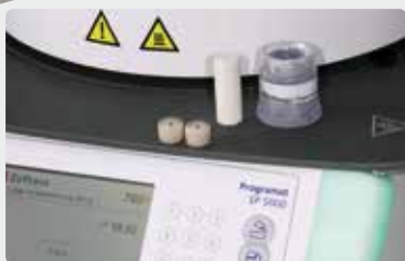
Kalten IPS Alox Kolben und kalte IPS InLine PoM-Rohlinge in der gewünschten Farbe bereitstellen.
