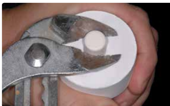
Dreht man den Alox-Kolben vorsichtig mit einer Zange aus der Einbettmasse so erhält man ihn bereits sehr sauber. Jedenfalls auf Sauberkeit überprüfen, ggfs. sandstrahlen mit \text{Al}_2\text{O}_3 .
