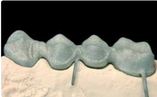
Nach dem Abstrahlen das Metallgerüst mit dem Dampfstrahler reinigen und gründlich trocknen lassen. Den Oxidbrand nach Herstellerangaben durchführen.
