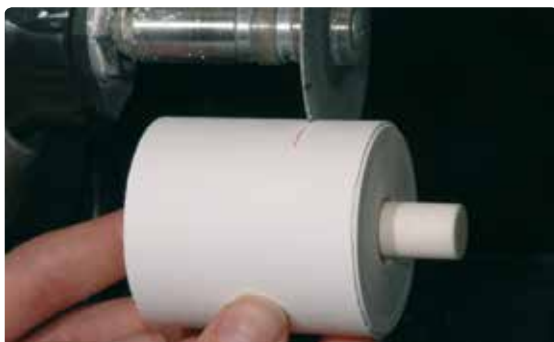
Muffel anschliessend an der markierten Stelle mit einer Trennscheibe trennen.
