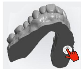
**!** Herausnehmbare Stümpfe sollten mit dem Buildstyle „PrograPrint PR5 Model horizontal“, ohne Stützkonstruktionen, direkt auf der Bauplattform platziert werden. Innerhalb eines Druckauftrags können unterschiedliche Buildstyles angewandt werden.
