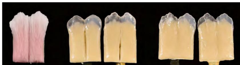
**01** — Vista de la serie de ensayos: Comportamiento de contracción. Izquierda: Aplicación de la cerámica sobre la prueba de metal. Centro: IPS d.SIGN Derecha: IPSStyle.
