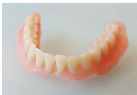
Abb. 12 Gebrochener Prüfkörper, bestehend aus zwei verklebten Zahnsegmenten (31–37 bzw. 41–47) nach dem Bruchversuch.
