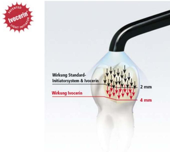
Abb. 11: Schematische Darstellung des 4-mm-Polymerisationsprozesses von Tetric PowerFill mit Ivocerin
