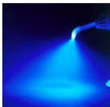
Abb 19b: Lichtstreuung eines verjüngenden Lichtleiters (13>8 mm)
