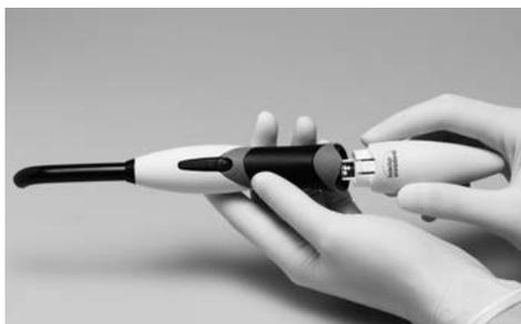
Óvatosan, erő kifejtése nélkül helyezze a kéziparabot a megfelelő tartóelemre a töltőn. Ha higiéniai védőhüvelyt használ, az akkumulátor töltése előtt távolítsa el. Ha lehet, a lámpát mindig teljesen feltöltött akkumulátorral használja. Ez meghosszabbítja az üzemelési élettartamot. Ezért javasoljuk, hogy minden páciens után helyezze a kéziparabot a töltőre. Ha az akkumulátor teljesen le van merülve, a töltési idő 2 óra.
