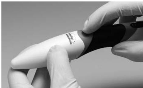
После этого отсоединить штекер блока питания с нижней стороны зарядного блока. При этом не следует тянуть за сетевую кабель.
