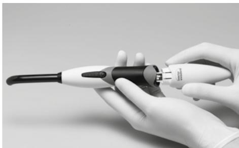
Vložte násadec bez použití síly do otvoru nabíjecí základny. Používá-li se hygienická ochrana, musí se před nabíjením baterie odstranit. Pokud je to možné, používejte lampu vždy s plně nabitou baterií. Tím se prodlouží její životnost. Doporučuje se proto násadec vložit po každém pacientovi do nabíjecí základny. V případě úplně vybité baterie trvá doba nabíjení 2 hodiny.
