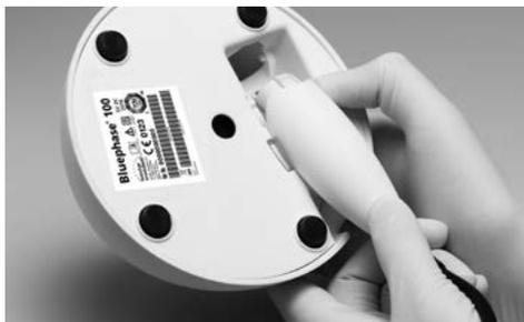
Introduceți fișa de contact drept în interiorul piesei de mână, până când auziți și simțiți că se înclichetează.
