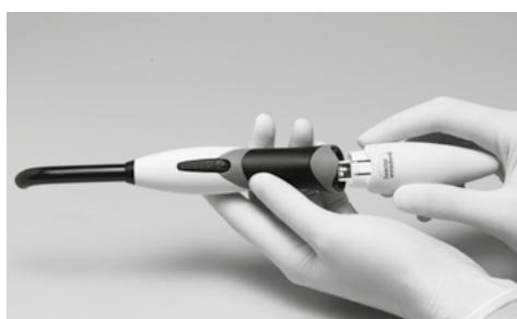
Reposer délicatement la pièce à main sur la base de chargement, à l'emplacement prévu à cet effet, sans forcer. Si vous utilisez une housse de protection, n'oubliez pas de la retirer avant de mettre la batterie en charge. Si possible, toujours utiliser la lampe avec une batterie complètement chargée, afin d'en prolonger la durée de vie. Il est conseillé de replacer la pièce à main sur la base de chargement après chaque patient. Le temps de charge d'une batterie vide est de 2 heures.
