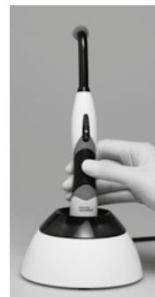
La batteria è un materiale di consumo, che generalmente deve essere sostituito dopo ca. 2 1/2 anni. L'età della batteria può essere rilevata dall'etichetta sulla batteria stessa.
