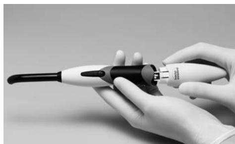
Colocar la pieza de mano con suavidad en el apoyo correspondiente de la base de carga. Si se utilizó la funda higiénica, por favor retirela antes de cargar la batería. Si fuera posible, utilice la lámpara siempre con una batería completamente cargada, ya que ello prolongará la vida útil. Por ello se recomienda colocar la pieza de mano en la base de carga después de cada paciente. El tiempo de carga para baterías vacías es de 2 horas.
