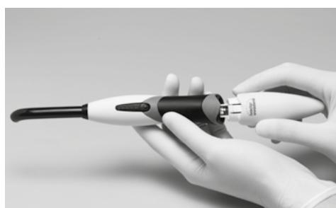
Inserire il manipolo nell'alloggiamento della base di ricarica senza esercitare forza. Se si utilizza un involucro di plastica (guaine monouso) per la protezione igienica, è necessario rimuoverlo prima di caricare la batteria. Utilizzare probabilmente l'apparecchio con batteria completamente carica per prolungarne la durata. Si consiglia pertanto di riporre il manipolo nella base di ricarica dopo ogni paziente. Quando la batteria è completamente scarica, il tempo di ricarica è di ca. 2 ore.
