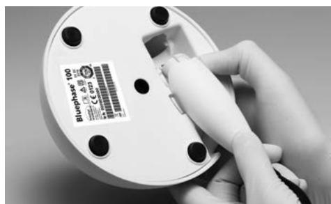
Inserte la clavija de conexión en la pieza de mano hasta que oiga y sienta que ha encajado en su posición.
