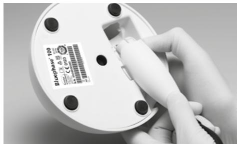
Insérer le cordon de branchement „power pack“ dans la pièce à main jusqu'à sentir et entendre un clic.
