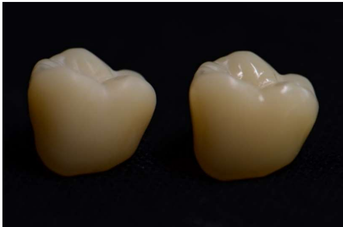
Abb. 15: Tetric CAD: Unpoliert direkt nach dem Schleifvorgang (links) und nach Politur mit OpraPol (rechts)
