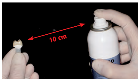
Sujete la restauración por la espiga IPS e.max CAD Crystallization Pin durante la aplicación.
