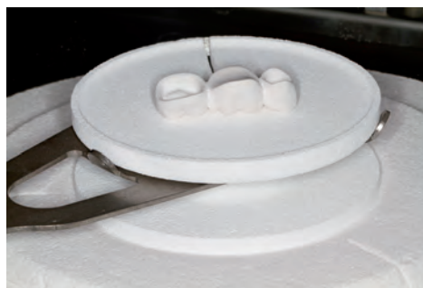
Coloque la bandeja de sinterización cargada en el centro del Programat CS4 usando la espátula de sinterización.
