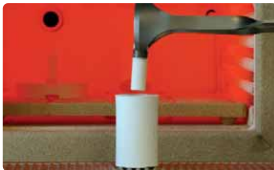
Colocar el pistón de óxido de aluminio caliente en el cilindro de revestimiento.
