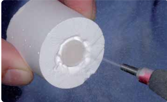
La eliminación gruesa del revestimiento se realiza con perlas de pulir de vidrio a 4 bar de presión (60 psi).
