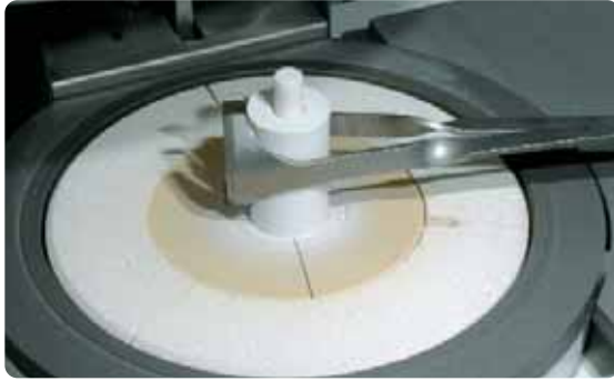
Colocación del cilindro de revestimiento en el horno de inyección
