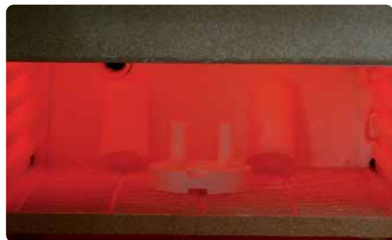
Colocar los cilindros de revestimiento y la bandeja IPS UniTray con los pistones de óxido de aluminio en el horno pre calentado.
