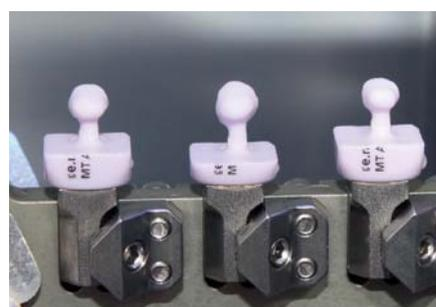
**11** — Coronas recién fresadas a partir de bloques de IPS e.max CAD MT en la máquina fresadora CAD/CAM.
