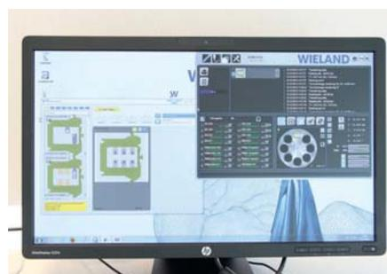
**10** — Software CAM del sistema Wieland Zenotec Select CAD/CAM con los bloques de IPS e.max posicionados en el portabloques.
