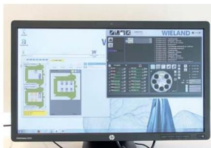
**10** — CAM-Software des Wieland Zenotec Select CAD/CAM-Systems mit den im Blockhalter positionierten IPS e.max-Blöcken
