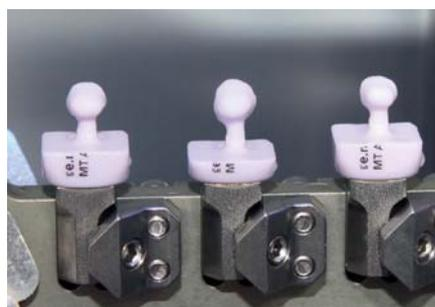
**11** — Fertig ausgeschliffene Kronen aus IPS e.max CAD MT-Blöcken in der CAD/CAM-Fräsmaschine
