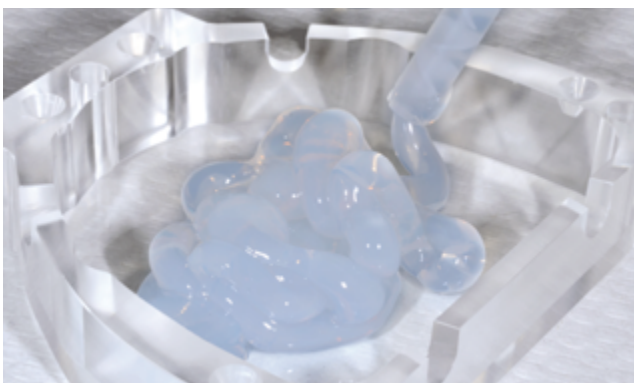
Abb. 16 und 17 Durch die Einfüll-Öffnungen im Kuvettendeckel der SR Nexco Flask kann nun der gesamte Hohlraum der geschlossenen Kuvette mit dem Klarsilikon Transil F aufgefüllt werden.
