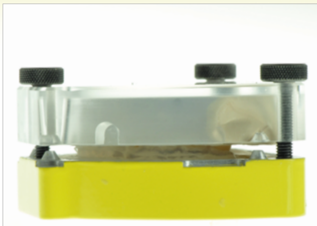
Abb. 19 und 20 Zum Schliessen der Küvettenhälften werden beide Teile zunächst locker aufeinander gesetzt. Sobald ein deutlicher Widerstand spürbar ist, werden die drei Feststellschrauben eingesetzt und mit jeweils ein bis zwei Umdrehungen pro Schraube langsam und sorgfältig nacheinander zugezogen.
