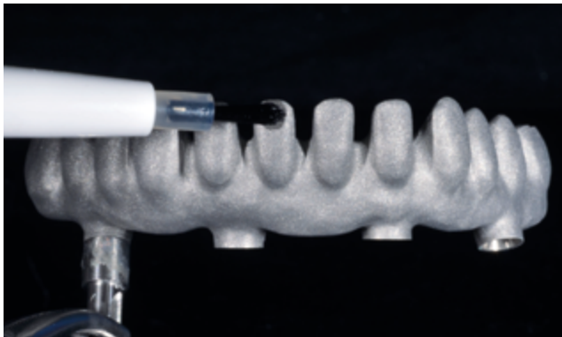
Abb. 19 und 20 ... und anschließend der Metall-Composite-Haftvermittler SR Link gleichmäßig dünn mit einem Pinsel aufgetragen.
