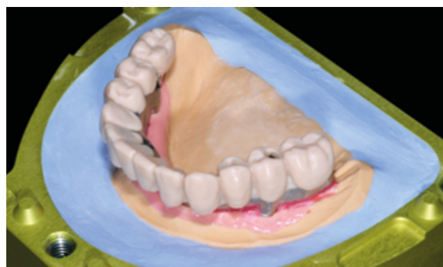
Abb. 9 Wenn keine Korrekturen mehr nötig sind, dann kann das Gerüst mit einem Knetsilikon der Shore-Härte 85 im Küvetten-Unterteil eingebettet werden.
