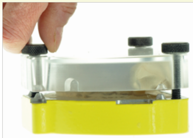
Abb. 19 und 20 Zum Schliessen der Küvettenhälften werden beide Teile zunächst locker aufeinander gesetzt. Sobald ein deutlicher Widerstand spürbar ist, werden die drei Feststellschrauben eingesetzt und mit jeweils ein bis zwei Umdrehungen pro Schraube langsam und sorgfältig nacheinander zugezogen.
