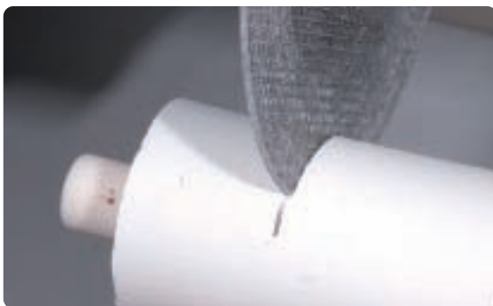
Muffel mit einer Trennscheibe separieren und an der Sollbruchstelle vorsichtig brechen.
