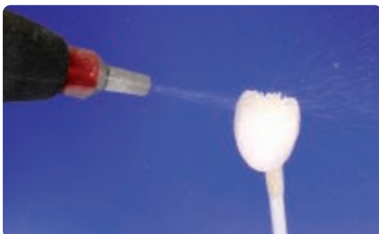
Abstrahlen der Restauration mit Al_2O_3 (Typ 100) mit 0.5 bar Druck.
