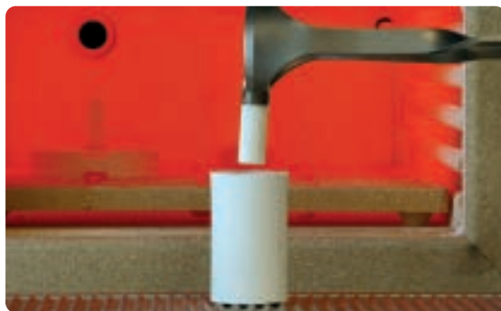
Bestücken der Muffel mit dem heissen AlOx-Kolben.
