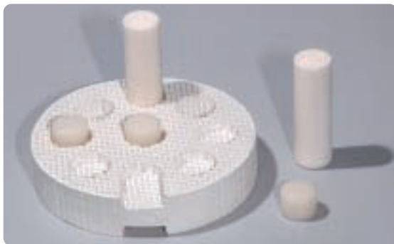
Positionierung der IPS Empress Esthetic Rohlinge und AIOx-Kolben auf dem IPS UniTray.
