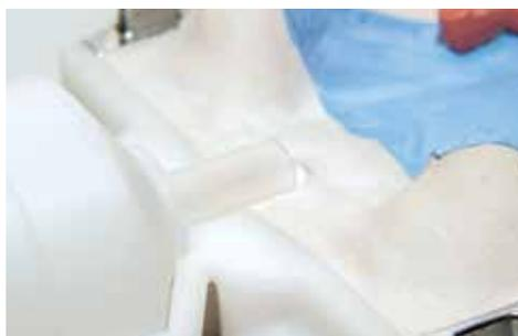
*Hinweis: Durch die Dichtungslippe des Trichters kann ein kleiner Spalt zwischen den Küvettenhälften entstehen, welcher jedoch im IvoBase Injector durch die Klemmbacken geschlossen wird.*
