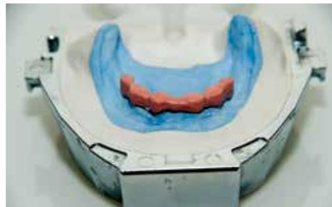
Um zu verhindern, dass während der Injektion Prothesenkunststoff zwischen die Metallkonstruktionen und in Unterschnitte der Pfeilerzähne oder -implantate fließt, müssen diese Bereiche ausgeblockt werden. Dazu eignet sich ein dünnfließendes additionsvernetzendes Silikon. Gleichzeitig wird die Tertiärstruktur in der korrekten Position fixiert.
