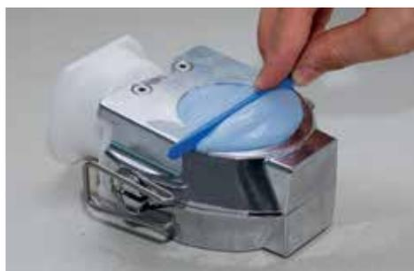
Der überstehende Gips muss anschliessend, z.B. mit dem IvoBase-Spatel, plan abgezogen werden, so dass kein Gips aus der Küvettenöffnung heraus steht.
