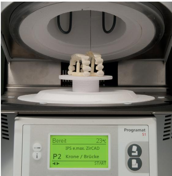
Abb. 14 Die Gerüste werden auf dem Sintertisch ohne Kugelbett aufrecht stehend gesintert.
