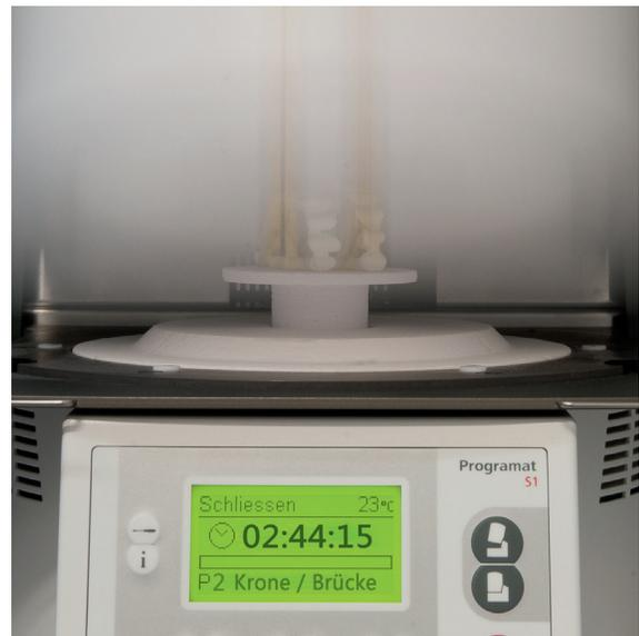
Abb. 15 Während des Schliessens der Ofenkammer wird die verbleibende Sinterzeit von weniger als 180 Min. angezeigt.
