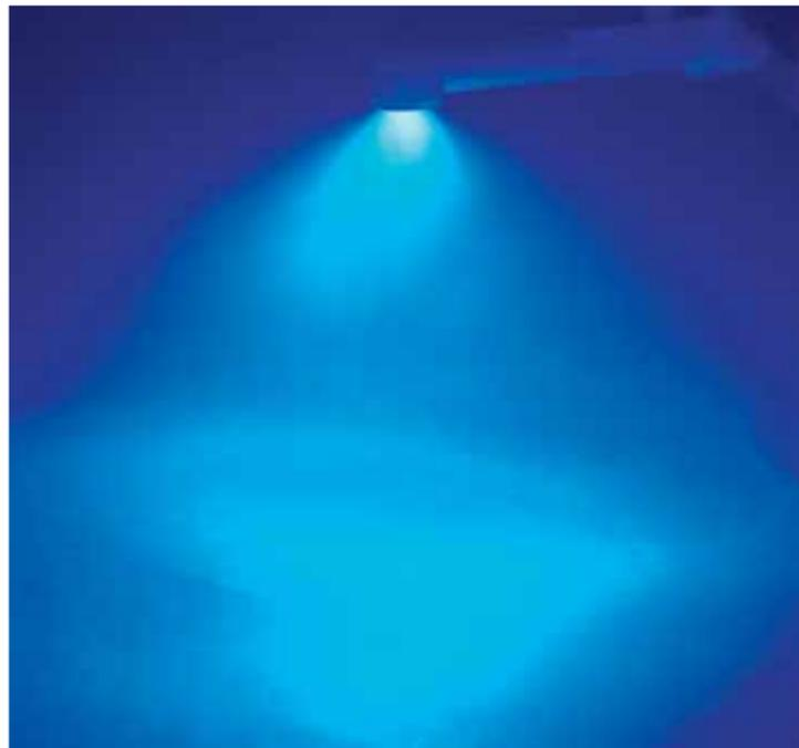
*Dispersión de la luz difusa de una unidad LED con diodos emisores de luz colocados directamente a las lentes.*
