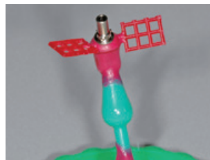
Pilar colado con aletas de ventilación
