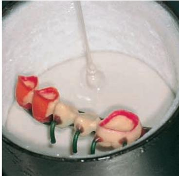
Ideale Gussergebnisse erreichen Sie wenn überschüssiges Wachsentspannungsmittel vollständig entfernt und die Abbindungszeit der Einbettmasse eingehalten wird.
