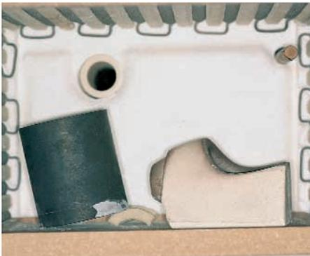
Für die Einbettung eignen sich phosphatgebundene bzw. gipsgebundene Einbettmassen. Phosphatgebundene Einbettmassen eignen sich für konventionelle oder schnelle Aufheizung.
