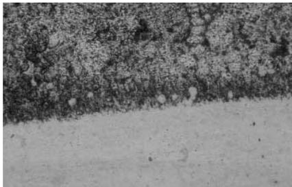
REM Aufnahme eines Diffusionsgefüges einer Lötstelle
