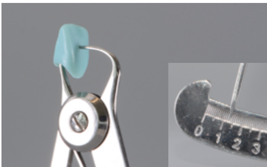
Manuelle Schichtstärkenbestimmung, zentral an der dünnsten vestibulären Stelle.
