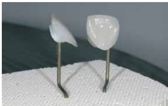
Restaurationen zum Brennen mit etwas IPS Object Fix Putty oder Flow auf den Brennpins des Wabenträgers fixieren.
