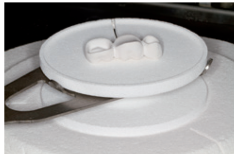
Den bestückten Sintertisch mit der Sintergabel mittig im Programat CS4 positionieren.
