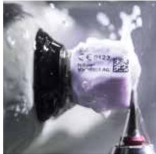
Eine in PrograMill One integrierte Kamera erfasst automatisch alle Informationen zu Materialien und Werkzeugen. Das macht die Verwendung unterschiedlicher Materialien genial einfach und die Bestückung der Maschine sehr komfortabel.
