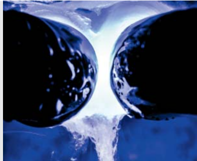
Abb. 13: Lichthärtung mit zwei Bluephase-Style-Polymerisationslampen unter Wasserkühlung
