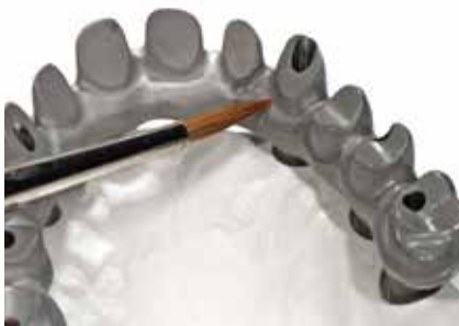
Abb. 7 Das Auftragen des Haftmittlers SR Link auf das sandgestrahlte CoCr-Metalgerüst für den Oberkiefer.
