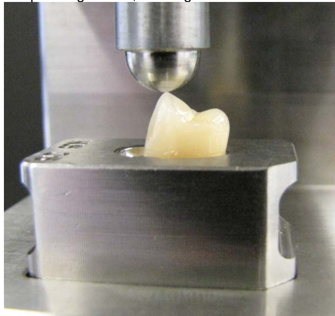
Abb 11: Versuchsaufbau für den Chippingtest.
