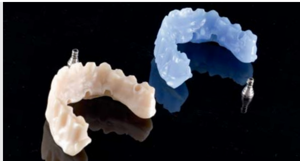
Fig. 5: Comparación de la construcción en cera y la estructura sinterizado.
