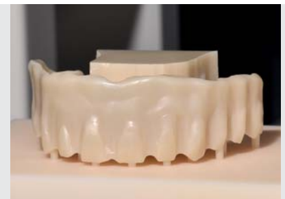
Fig. 3: Sinterización de la estructura. Pequeños sinter drops en la estructura apoyan la restauración durante la sinterización.
