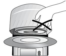
El horno tiene un motor eléctrico y se acciona por medio de controles electrónicos. No abrir nunca el cabezal a mano, ya que se puede dañar el mecanismo.
