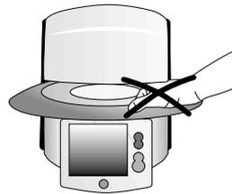
Nunca deslice la mano ni otras partes del cuerpo debajo del cabezal del horno durante el funcionamiento, ya que existe riesgo de aplastamiento y quemadura.
