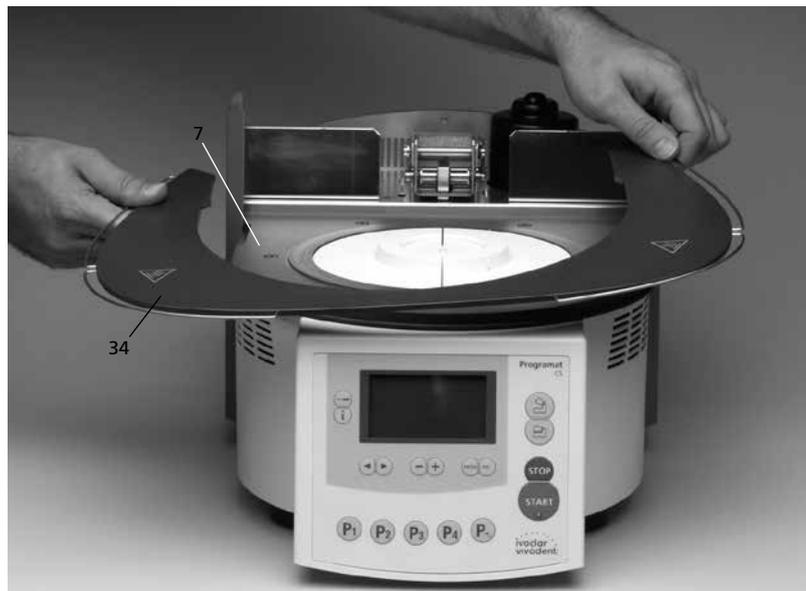
Asegure la plataforma de apoyo (34) con los dos tornillos (35) incluido la junta de silicona (47).
