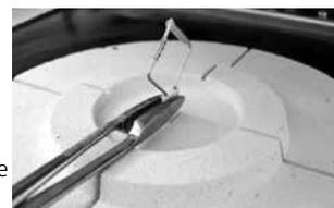
4. Si fuera necesario, utilice las pinzas del horno para aplicar una ligera presión en el centro de la base de calibrado, hasta que la pieza de calibrado encaje en su sitio. Tenga en cuenta las marcas correspondientes.
