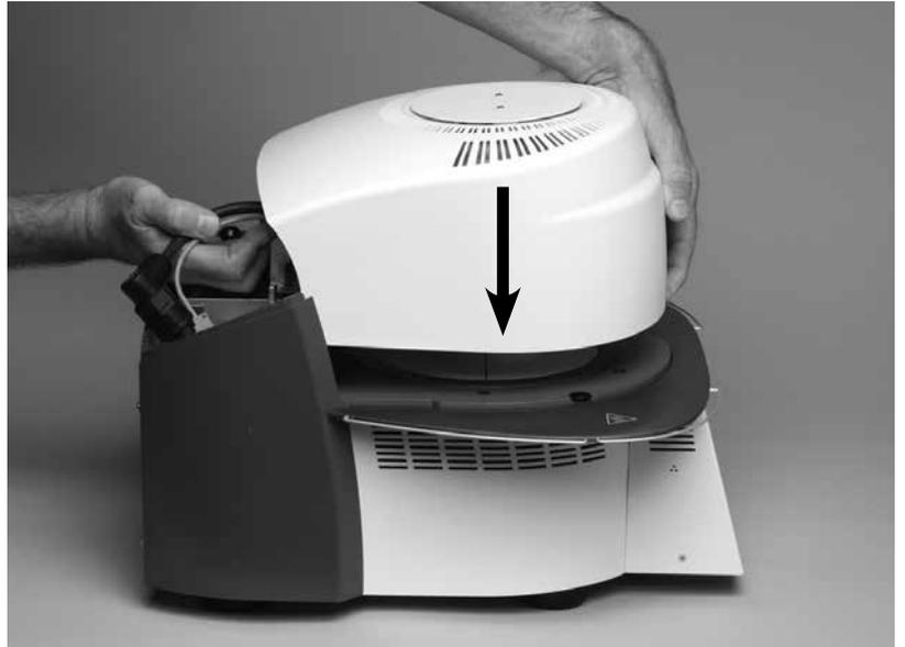
Asegúrese de que la marca sobre el soporte del cabezal del horno (41) este alineado con la marca del soporte de la base del horno (42).
