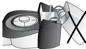
El cabezal del horno no se deberá retirar de la base del horno, mientras que el cabezal esté conectado por medio del cable electotérmico.
