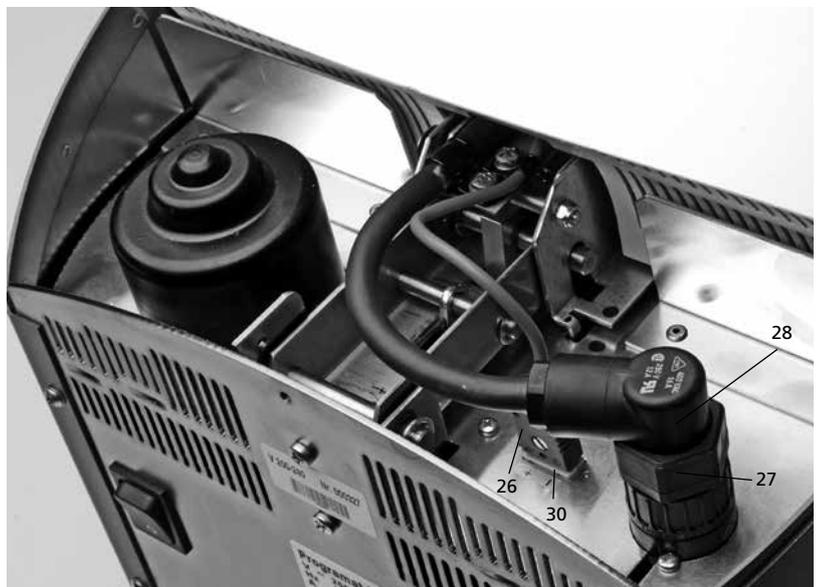
Asegure el enchufe de la resistencia (28) enroscando el seguro del enchufe de la resistencia (27) hasta que quede bien sujeto.
