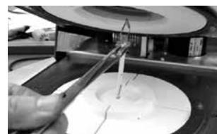
7. Reemplace la plataforma de cocción utilizando las tenazas del horno.
