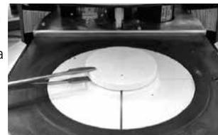
3. Agarre con cuidado la parte superior de ATK 2 utilizando las pinzas del horno (Atención: Riesgo de fractura de la cerámica) e insértelo en las ranuras destinadas para este fin hasta que encajen en su sitio. La orientación de la muestra de calibrado (derecha o izquierda) no es importante.
