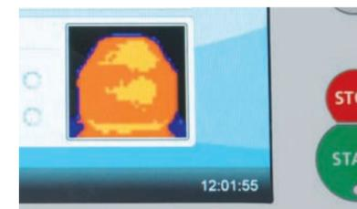
Mientras que los objetos estén cargados, la pantalla muestra la imagen IR del cilindro de revestimiento.
