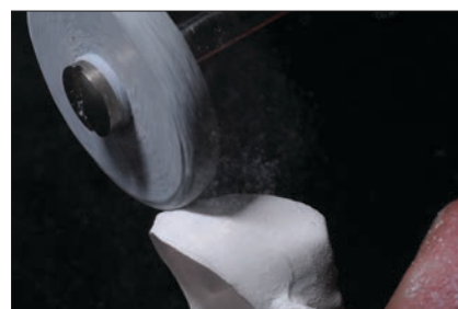
Suavizar los puntos de inserción de los pines de sujeción
