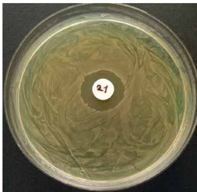
Abb. 15 Hemmhof gegen S. mutans : Hemmhof um einen Komposit-Prüfkörper mit einem chlorhexidinhaltigen Experimental-Lack. Innerhalb dieser Zone ist kein trüber Bewuchs durch Bakterien zu erkennen (F&E Biotechnologie, Ivoclar Vivadent AG, Februar 2006)
