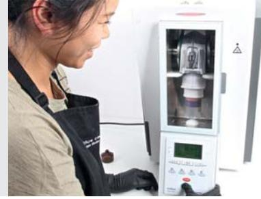
Fig. 6: La cubeta es colocada en el inyector junto con el material IvoBase mezclado y se inicia el programa.
