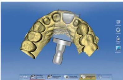
Fig. 9: Después de la construcción de las coronas se efectuó el rectificado de las coronas fabricadas con bloques de disilicato de litio (IPS e.max CAD HT C14/A2).
