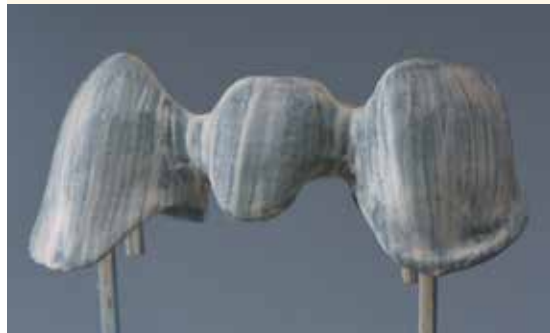
IPS Style Ceram Paste Opaquer nach dem 1. Opaquerbrand
