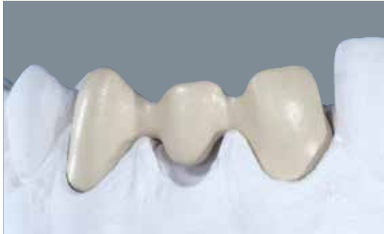
IPS Style Ceram Powder Opaquer nach dem 2. Opaquerbrand
