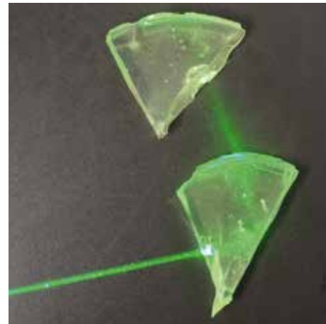
Abb. 3 Hier wird der Laserstrahl beim Ein- und Austritt aus dem Körper gebrochen.
