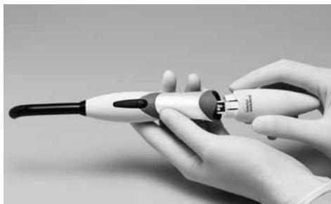
Не применяя усилие, вставить наконечник в отверстие на зарядном блоке. Если применяется гигиеническая защита, ее следует удалить перед зарядкой аккумулятора. По возможности прибор постоянно использовать с полностью заряженным аккумулятором – это обеспечивает длительный срок службы. Поэтому рекомендуется после каждого пациента вставлять наконечник в зарядный блок. Зарядка полностью разряженного аккумулятора длится 2 часа.
