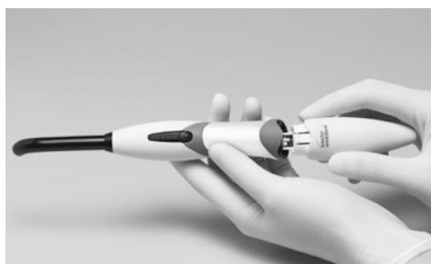
Placera försiktigt handstycket i det avsedda urtaget på laddningsstationen. Om ett hygienskydd används ska det avlägsnas innan du laddar batteriet. Om möjligt, använd alltid lampan med fulladat batteri, eftersom det kommer att förlänga lampans livslängd. Vi rekommenderar därför att handstycket återplaceras i laddningsstationen efter varje patient. Laddningstiden för ett helt tomt batteri är 2 timmar.
