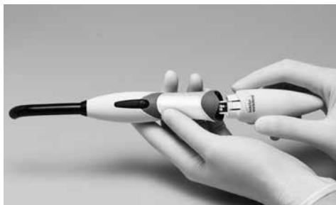
El aletini şarj ünitesindeki yuvasına nazikçe yerleştirin. Bir hijyen kılıfı kullanılıyorsa, lütfen pil şarj etmeden önce kılıfı çıkarın. Mümkünse, ışık cihazını daima tam şarjlı bir pille kullanın. Bu durum hizmet ömrünü uzatacaktır. Bu nedenle, el aletini her hastadan sonra şarj ünitesine yerleştirmeniz tavsiye edilir. Pil tamamen boşalmışsa, şarj süresi 2 saatir.
