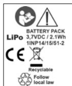
Προσέξτε, οι μπαταρίες λιθίου-πολυμερούς μπορεί να αντιδράσουν με έκρηξη, πυρκαγιά και έκλυση καπνού σε περίπτωση ακατάλληλου χειρισμού ή μηχανικής βλάβης. Μην χρησιμοποιείτε κατεστραμμένες μπαταρίες λιθίου-πολυμερούς.
