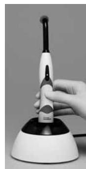
Akumulator jest częścią zamienną, która ulega zużyciu. Zazwyczaj po upływie 2,5 roku powinien być wymieniony na nowy. Data produkcji akumulatora jest podana na naklejce, na jego obudowie.
