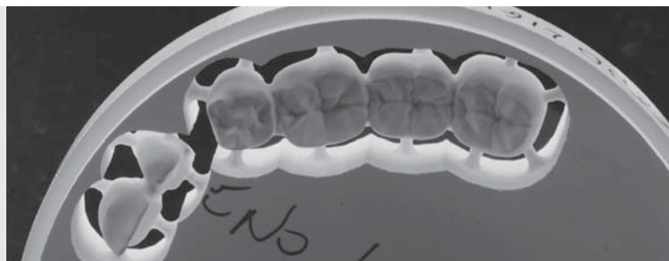
Fig. 11: Después del fresado de las construcciones a partir del óxido de circonio Zenostar T teñido (Wieland Dental).
