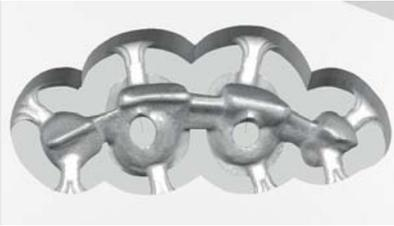
Fig. 6: Visualización CAD del armazón atornillado en el módulo CAM.
