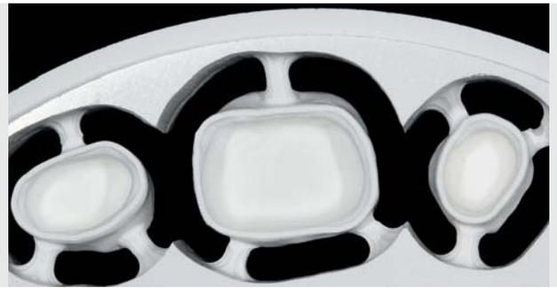
Abb. 8: Die gefrästen Kronen vor dem Heraustrennen aus dem Zirkoniumoxid-Blank
