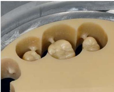
Abb. 5: Die gefrästen Kronen vor dem Heraus-trennen aus dem PMMA-Blank
