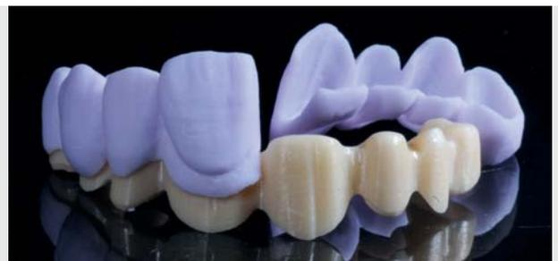
Abb. 11: Nach dem Schleifen der Verblendung (Lithium-Disilikat-Struktur)
