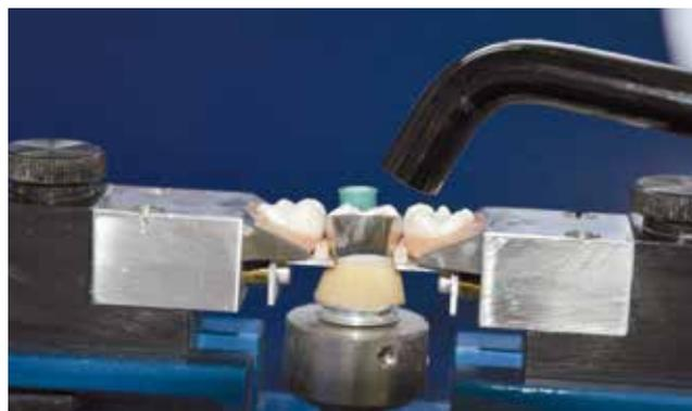
Abb. 8: Schräge Position des Lichtleiters und 5 mm Abstand vom Zahn
