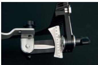
Anzeige des Winkels der Okklusionsebene zur Camper'schen Ebene auf der CE-Skala.
