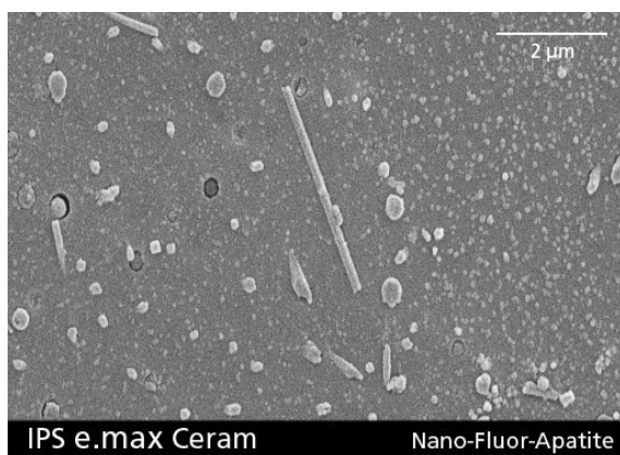
Abb. 1: Gefüge von IPS e.max Ceram (REM-Aufnahme): unterschiedliche Grössen der Fluorapatitkristalle
