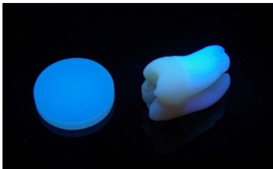
Abbildung 9: Fluoreszenz von Variolink Esthetic (Farbe „neutral“) im Vergleich zum natürlichen Zahn. F&E Ivoclar Vivadent AG, Schaan, 2014
