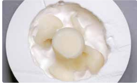
La eliminación gruesa del revestimiento se realiza con perlas de pulido a 4 bar de presión hasta que las piezas sean visibles.
