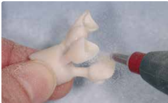
Quite completamente la capa de reacción de las superficies de contacto con \text{Al}_2\text{O}_3 a una presión de 1–2 bares.
