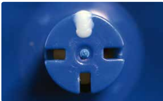
Selle las aberturas que no vaya a utilizar de la base del cilindro de revestimiento con una cantidad abundante de cera.
