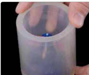
Con cuidado coloque el IPS Silicone Ring 200 g sobre la IPS Multi Investment Ring Base 200 g. Asegúrese de que el cilindro quede enrasado con la base del cilindro de revestimiento.
