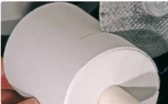
Separe el cilindro de revestimiento por medio de un disco de separación y rómpalo en el punto de rotura predeterminado.
