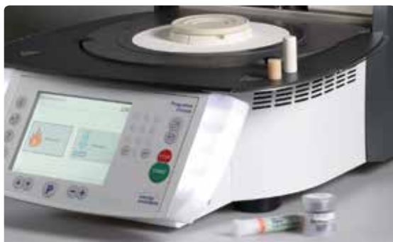
Prepare un pistón IPS Alox Plunger aislado frío y una pastilla IPS e.max Press fría del color deseado.
