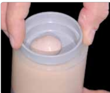
Llene el cilindro de revestimiento hasta la marca que se muestra y coloque el IPS Ring Gauge con un movimiento basculante. El material de revestimiento sobrante saldrá por la abertura. Deje que el cilindro de revestimiento fragüe sin manipularlo.
