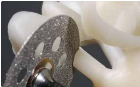
Separe los bebederos con un disco diamantado fino y refrigere constantemente con agua la zona de repaso.
