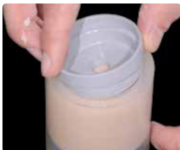
Llene el cilindro de revestimiento hasta la marca que se muestra y coloque el IPS Ring Gauge con un movimiento basculante. El material de revestimiento sobrante saldrá por la abertura. Deje que el cilindro de revestimiento fragüe sin manipularlo.
