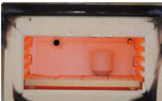
Coloque el cilindro de revestimiento en el horno de presecado con la abertura hacia abajo.
