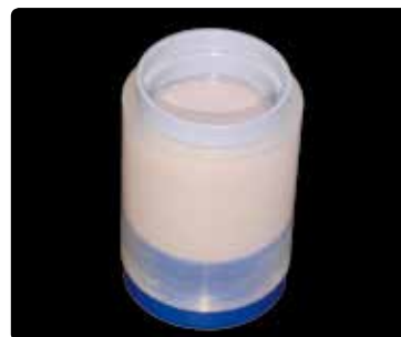
Llene el cilindro de revestimiento hasta la marca que se muestra y coloque el IPS Ring Gauge con un movimiento basculante. El material de revestimiento sobrante saldrá por la abertura. Deje que el cilindro de revestimiento fragüe sin manipularlo.
