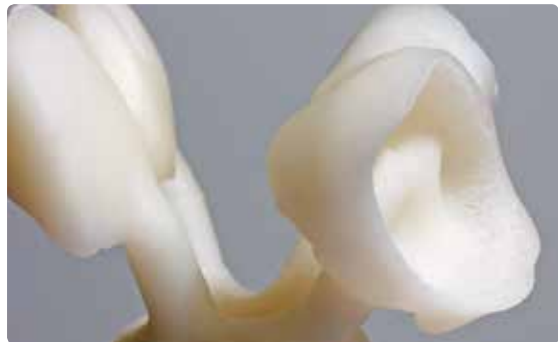
Quite la capa de reacción que se forma sobre los objetos inyectados con el Invex Liquid en un baño de ultrasónicos.
