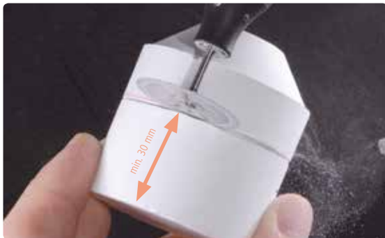
Separe el cilindro de revestimiento a una distancia de al menos 30 mm de la superficie inferior con un disco de separación...
