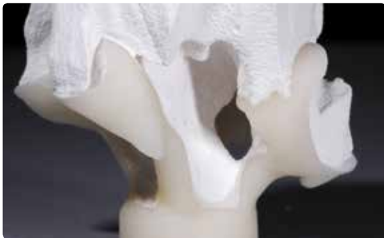
La eliminación fina del revestimiento se realiza con perlas de pulido a 2 bares de presión.
