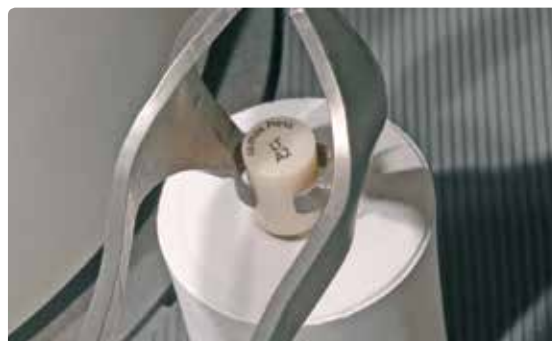
Coloque la pastilla IPS e.max Press fría en el cilindro de revestimiento caliente con la cara impresa hacia arriba.
