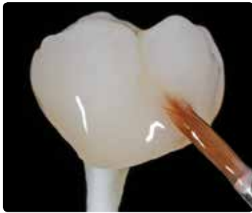
Aplique el glaseado uniformemente sobre la superficie.
