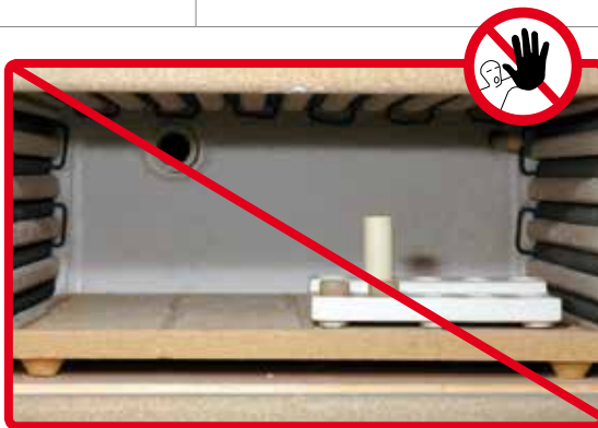
No pre caliente las pastillas IPS e.max Press ni AloX Plunger.
