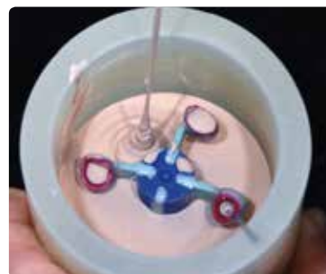
Vierta lentamente el material de revestimiento en el cilindro de revestimiento de forma que el material lo llene de forma continua.
