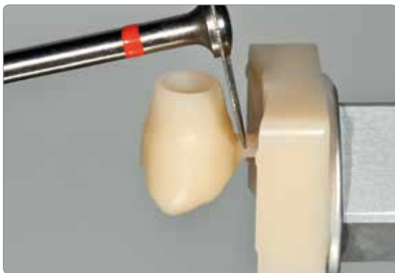
Abtrennen der Ansatzstelle von inzisal mittels einer feinen kreuzverzahnten Fräse oder einer diamantierten Trennscheibe.
