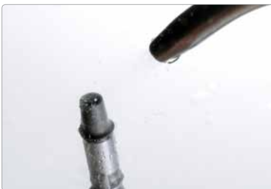
Silikon entfernen und anschließende Reinigung mittels Ultraschall im Wasserbad oder Dampfstrahler.
