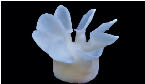
Fig. 4 Las estructuras de soporte fabricadas mediante la técnica de inyección a presión (IPS e.max Press LT) sólo tenían un espesor de aprox. 0,3 mm. Queríamos aprovechar las propiedades ópticas de la pieza en bruto translúcida (Low Translucency).
