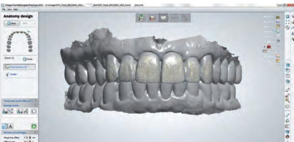
Fig. 6 Los diferentes colores del software permitieron reconocer las diferencias entre la configuración final de las coronas y las coronas provisionales (diseño propuesto de las coronas: amarillo, escaneo previo a la preparación: gris).
