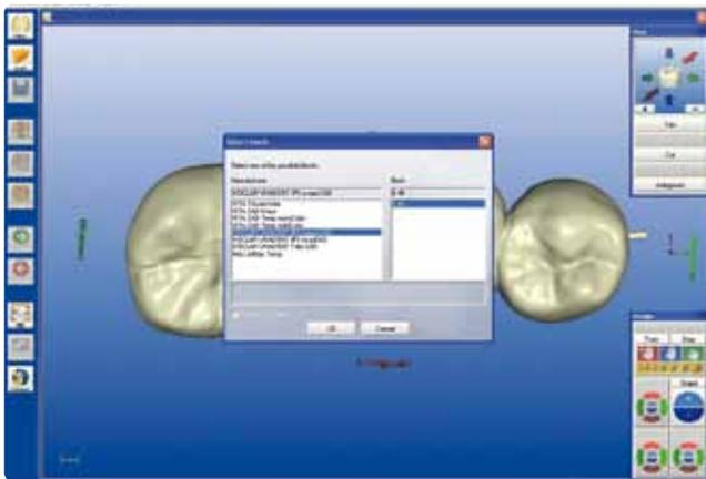
Antes del proceso de fresado de la estructura de blindaje, en selección de bloque, elija *Ivoclar Vivadent IPS e.max CAD* y el *tamaño de bloque deseado*. Seguidamente inicie el proceso de fresado.
