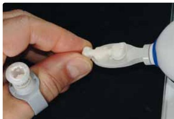
... distribuya uniformemente el material IPS e.max CAD Crystall./Connect con el vibrador.
