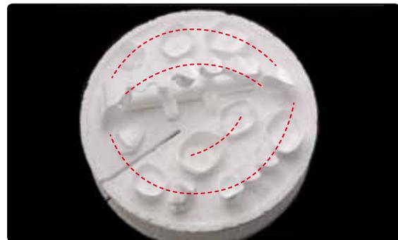
Se pueden sinterizar simultáneamente estructuras con o sin estructura de apoyo de sinterizado. Tenga en cuenta la selección de programa. Las estructuras no se deben tocar entre ellas. No coloque estructuras sobre la separación en la bandeja de sinterización.
