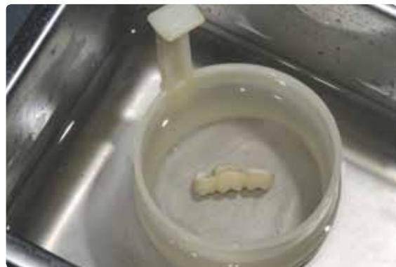
Elimine los residuos adheridos de IPS Object Fix Putty o Flow con ultrasonido en baño de agua y/o con chorro de vapor.
