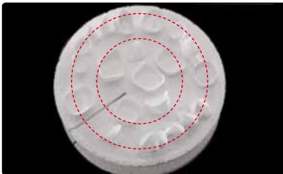
Coloque las estructuras I en círculos concéntricos sobre la bandeja de sinterización. Esto asegura una distribución uniforme de la temperatura dentro de la estructura durante el calentamiento y enfriamiento.
