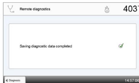
Si el horno se conectara a un ordenador portátil / PC a través de Ethernet, el archivo también puede abrirse directamente, reenviarse o ser analizado por el software PrograBase.
