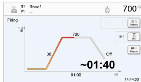
La tecla **IRT** (consulte el Capítulo 5.1.2) se utiliza para pasar a la vista de la cámara de infrarrojos durante el proceso de cierre y presecado. La tecla correspondiente se vuelve a pulsar para volver a la pantalla de la curva de cocción.
