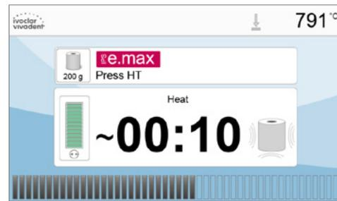
El cabezal del horno se abre automáticamente al final del programa. El panel de resultados muestra el tiempo de inyección, distancia de inyección y la temperatura del cilindro de revestimiento, si estuviera activado el análisis del cilindro de revestimiento de IRT, en el momento de la carga.
