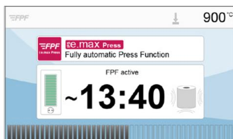
El horno se abre automáticamente al finalizar el programa. En el panel de resultados se indica el tiempo y distancia de inyección.
