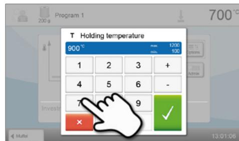
La temperatura de mantenimiento se cambió satisfactoriamente. Todos los demás parámetros mostrados en la curva de cocción pueden cambiarse / editarse de la misma forma.
