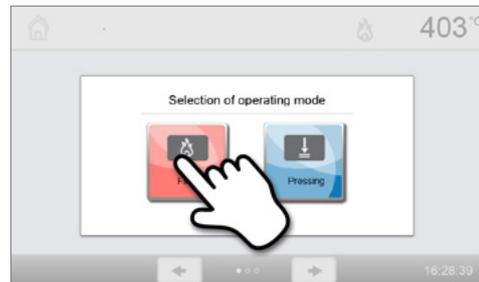
2. Tras seleccionar el modo de funcionamiento, se muestra una nota que indica las diferentes temperaturas de espera de los modos de funcionamiento correspondientes.
